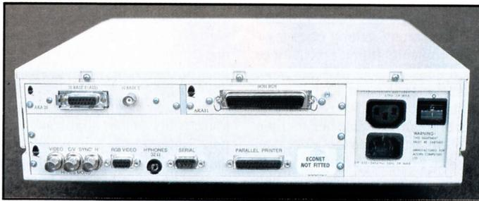
**Bild 5** Rückansicht des R260 mit den sauber beschrifteten Anschlüssen
