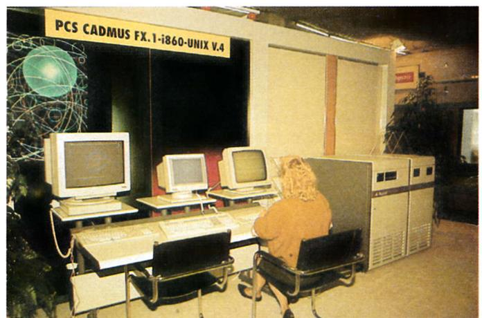
**Bild 7** Der **Alliant-Supercomputer FX/2800**, auf der Messe als Server mit **Cadmus-Workstations** zur **Finite-Elemente-Berechnung** gekoppelt
