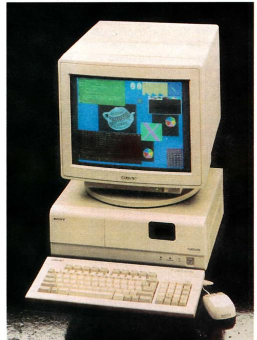
**Bild 6** In der Highend-Workstation **NWS-3860** von Sony werden zur Leistungserhöhung mehrere Prozessoren eingesetzt
